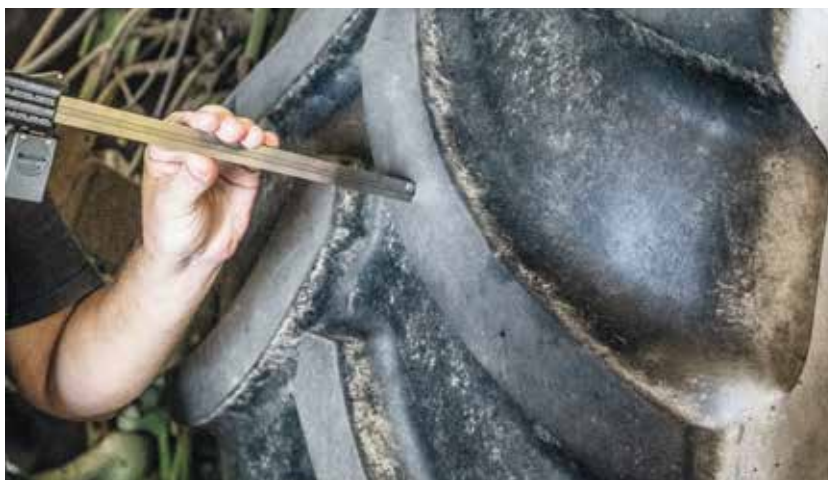
Bild 3: Verschleißmessung mit Tiefenanschlag
