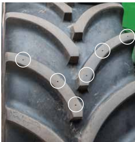
Bild 2: Messstellen an einem Stollenpaar
